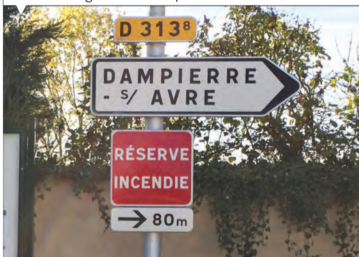
Panneau de signalisation indiquant la localisation d'un P.E.I.
