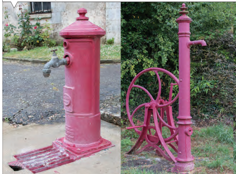
Borne de puisage et pompe à roue
